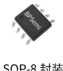
S4723MB 采用 SOP-8 封装
